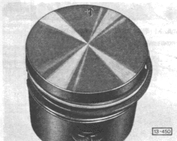
Abb. 3 Kolben – Einbaulage Pfeil zeigt zur Riemenscheibe. Beim Ausbau Zugehörigkeit zum Zylinder kennzeichnen.
