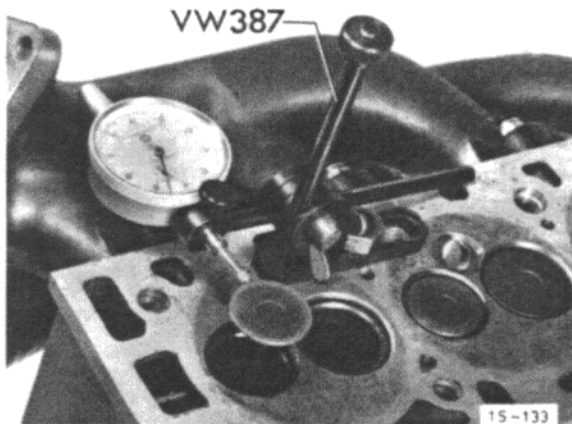
Abb. 10 Ventilführung, Verschleiß messen
