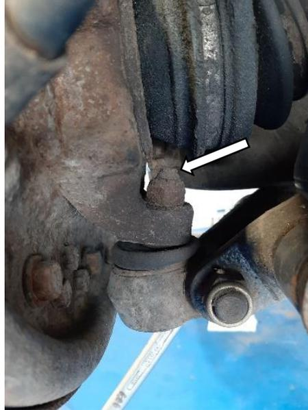
6) Beide selbstsichernde Muttern lösen und entfernen.
