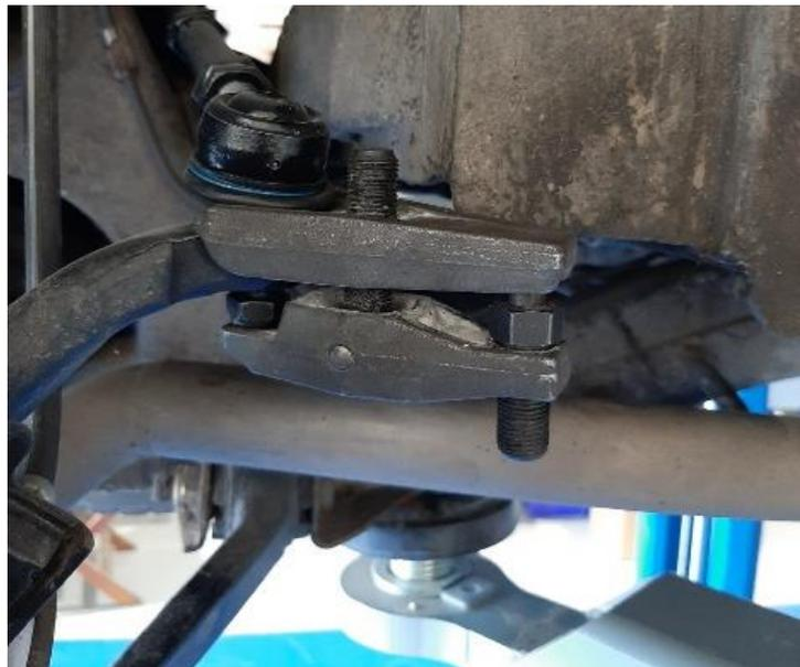
**10)** Beide Bolzen / Schrauben des Führungsgelenk entfernen.
