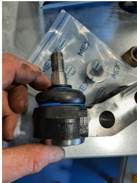
2) Führungsgelenk von unten in den Konus einführen und anschließend die beiliegende Mutter aufdrehen.
