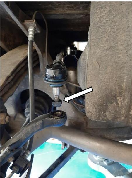
**13)** Die Mutter des Führungsgelenk kann nun komplett abgedreht werden. Ist dies nicht möglich, muss die Mutter gesprengt oder abgetrennt werden.
