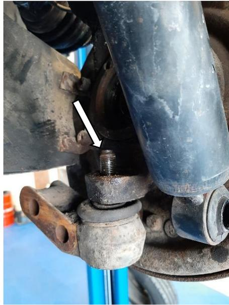
**14)** Das Führungsgelenk kann nun mittels passendem Abdrücker vom Radlagergehäuse getrennt werden. Klemmt dies sehr stark, kann mittels Hammerschlag auf das Radlagergehäuse für Entspannung gesorgt werden.
