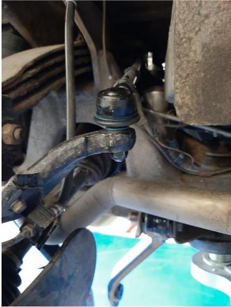
7) Zentralmutter reinigen und Dichtring / Feder aufsetzen. Handfest anziehen.
