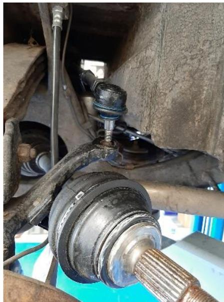
4) Spurstange lösen und Mutter aufsetzen (schützt vor Beschädigung des Gewindes). Radlagergehäuse drehen (ggf. nach vorne anheben – Bremsschlauch beachten!) und Achswelle einführen. Ggf. einen Wagenheber zur Unterstützung verwenden.
