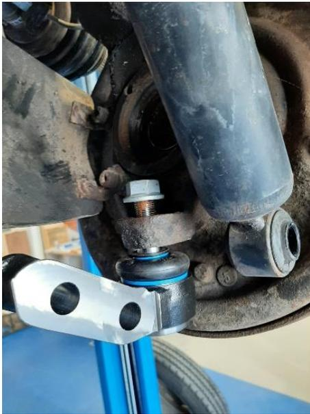
3) Kontrolliere den Dichtring am Gleichlaufgelenk der Achswelle. Bei Beschädigung ersetzen. Dichtring neu fetten erleichtert die Montage. Passfläche auf Radnabenseite muss sauber und rostfrei sein.
