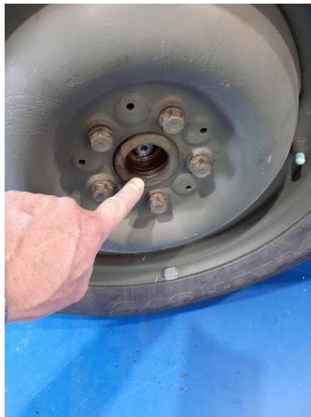
4) Radnabe reinigen und Rost entfernen.
