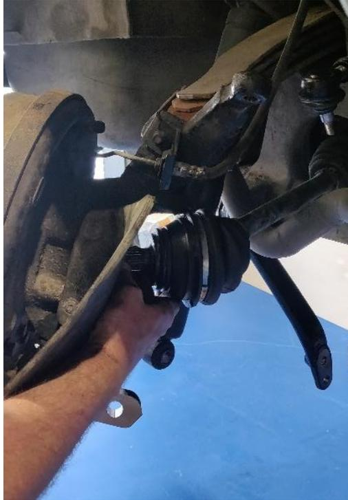
**12)** Spurstange kann wieder leicht eingehängt werden. Mutter nur einige Umdrehungen aufsetzen.
